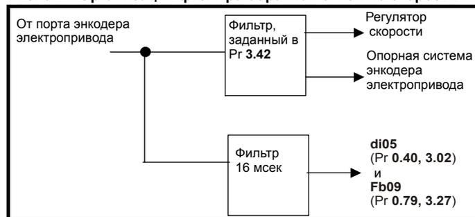
На Рис. 6-1 показано устройство фильтра. Следует отметить, что такой же фильтр на входе регулятора скорости действует и для di05 (Рг 0.40, 3.02), если обратная связь поступает с дополнительного модуля, но диапазон окна фильтра управляется параметром Рг x.19.
