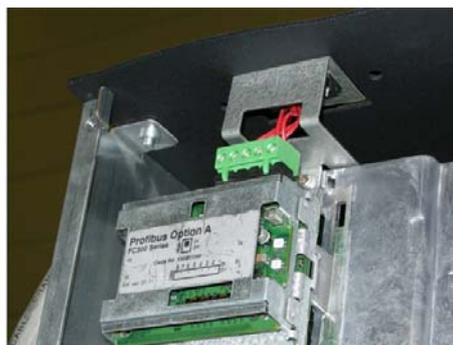
Рисунок 4.16: Верхнее подключение шины.
