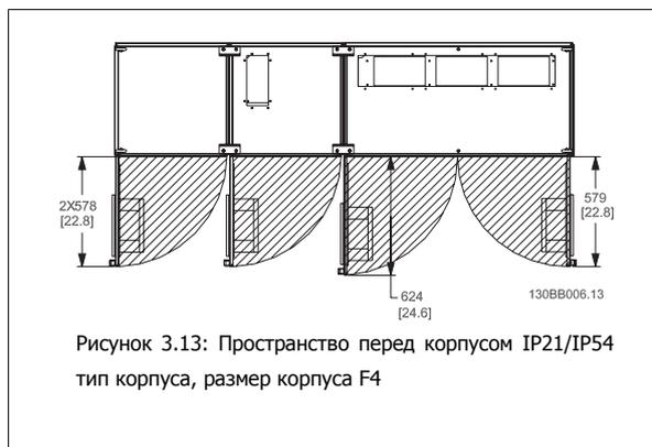
Рисунок 3.13: Пространство перед корпусом IP21/IP54
