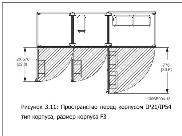
Рисунок 3.11: Пространство перед корпусом IP21/IP54
