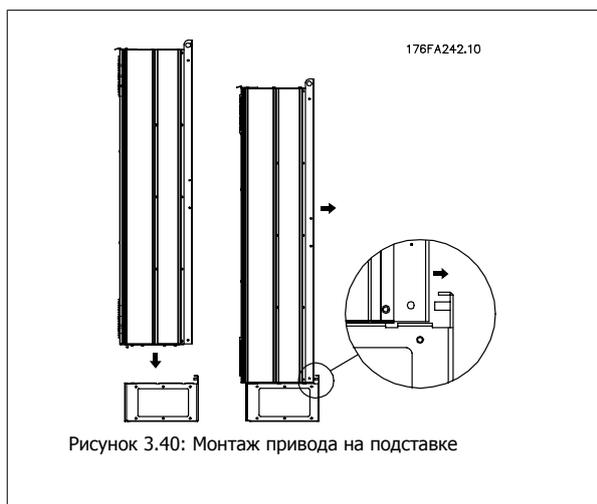
Рисунок 3.40: Монтаж привода на подставке
