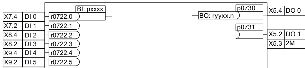
Изображены Внутреннее соединение входов и выходов е 6-1
