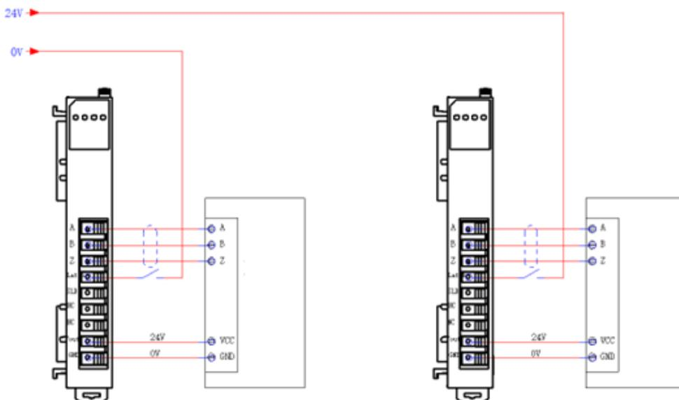
Рисунок 4-21. Схема подключения модуля энкодера SM600101/SM601102
