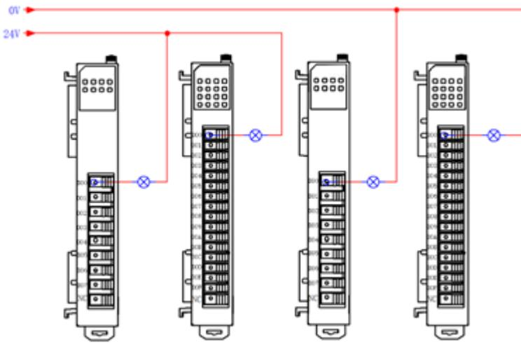
Рисунок 4-13. Схема подключения модулей SM310802/SM310H04
