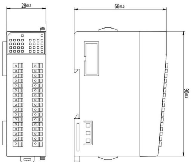
Рисунок 4-6. Габаритные размеры для SM213S18, SM313S19.
