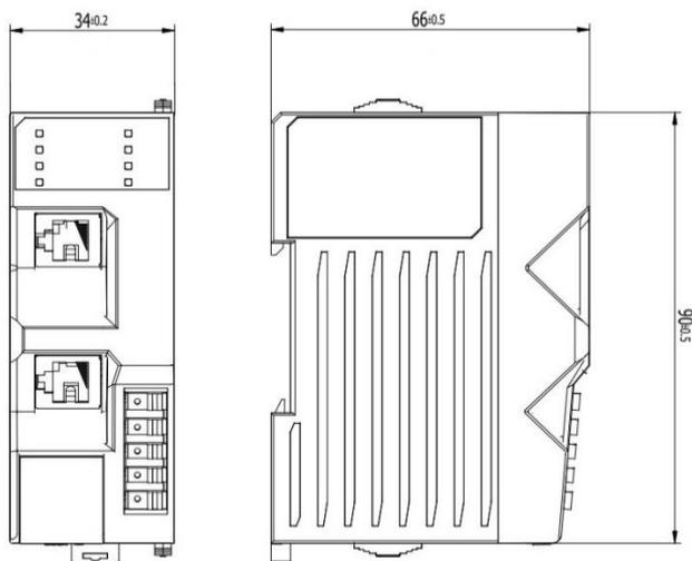
Рисунок 4-1. Размеры коммуникационного модуля SM111005, SM110204
