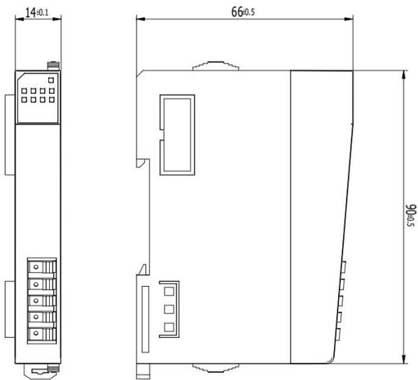
Рисунок 4-10. Габаритные размеры модуля питания SM010001
