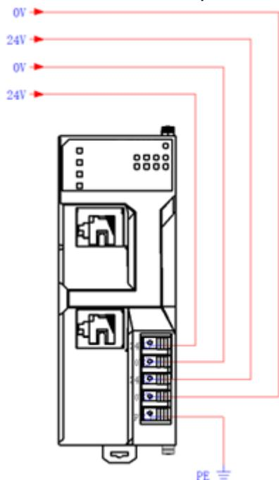
Рисунок 4-11. Схема подключения коммуникационного модуля
