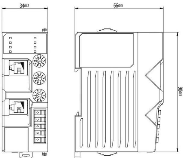
Рисунок 4-4. Размеры коммуникационного модуля SM112108, SM113007
