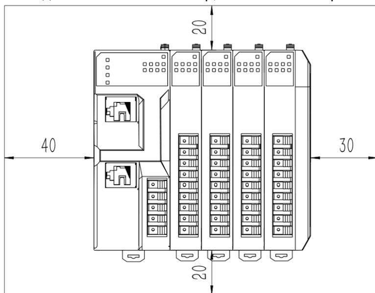
Рисунок 3-1. Минимальный монтажный зазор
