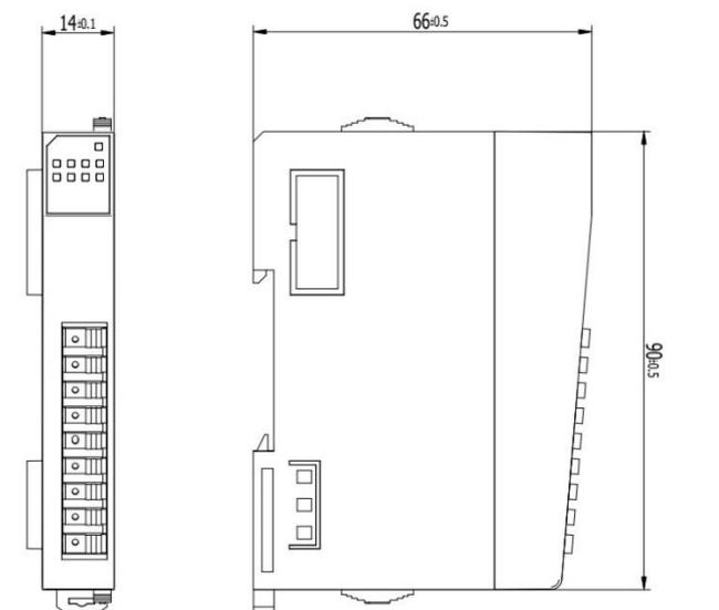
Рисунок 4-7. Габаритные размеры SM210802, SM310802, SM320805, SM401401, SM441409, SM441410, SM445411, SM445412, SM405405, SM415407, SM501401, SM541409, SM545411, SM545412, SM511403, SM505405, SM515407, SM465413, SM465418, SM465414, SM465417, SM600101, SM601102, SM602103, коммуникационного модуля Modbus SM632114.
