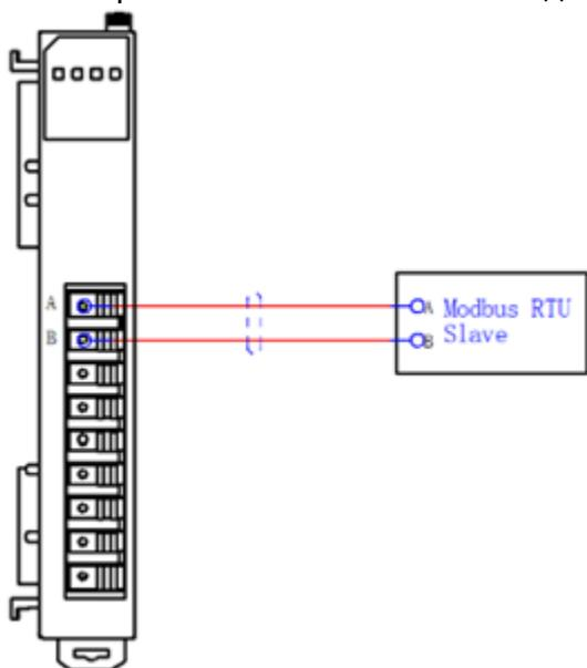
Рисунок 4-23. Схема подключения модуля SM632114
