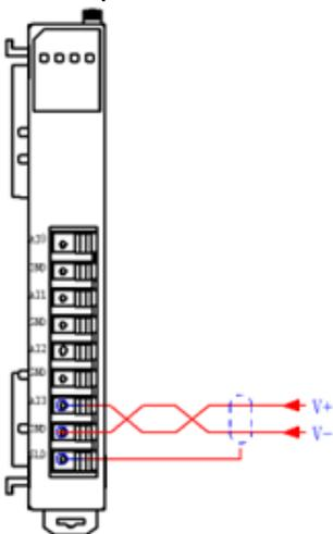
Рисунок 4-15. Схема подключения входных сигналов напряжения
