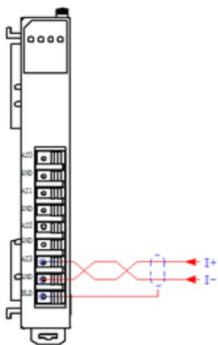
Рисунок 4-16. Схема подключения входных токовых сигналов
