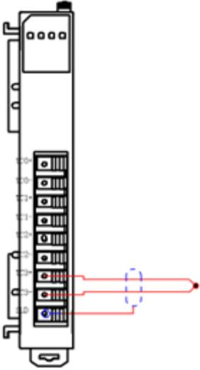
Рисунок 4-19. Схема подключения модуля SM465413
