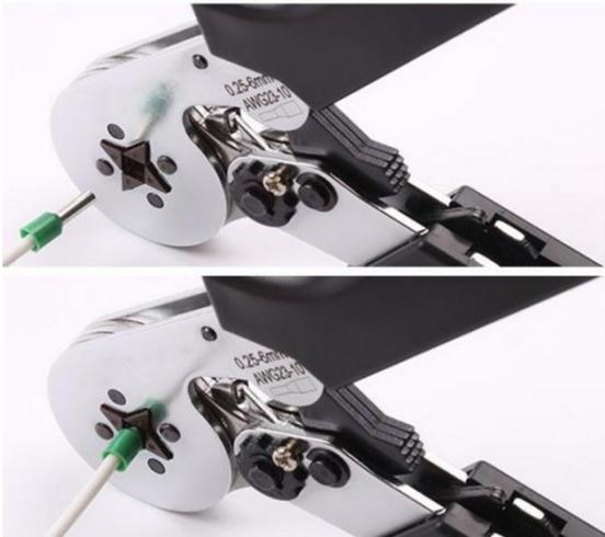
Рисунок 3-5. Процесс обжима проводов
