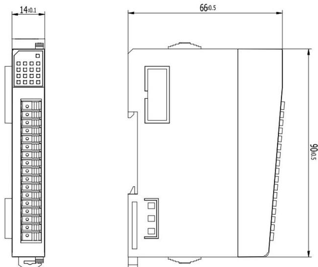
Рисунок 4-5. Габаритные размеры для SM210H04, SM310H04, SM401829, SM411831, SM441833, SM441834, SM501813, SM541817, SM541818, SM511815, SM475423, SM475426, SM475428.
