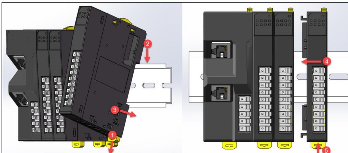
Рисунок 3-3. Добавление модуля ввода/вывода
