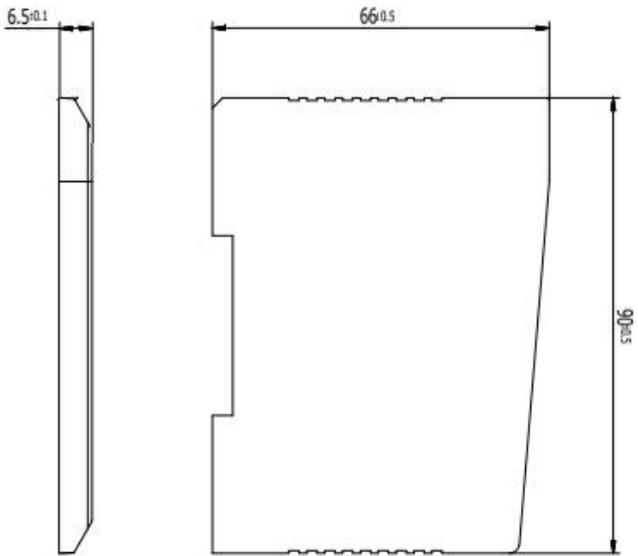
Рисунок 4-9. Габаритные размеры клеммного модуля SMETR0100
