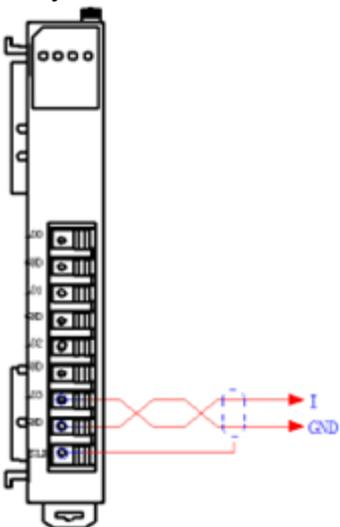
Рисунок 4-18. Схема подключения входного/выходного токового сигнала
