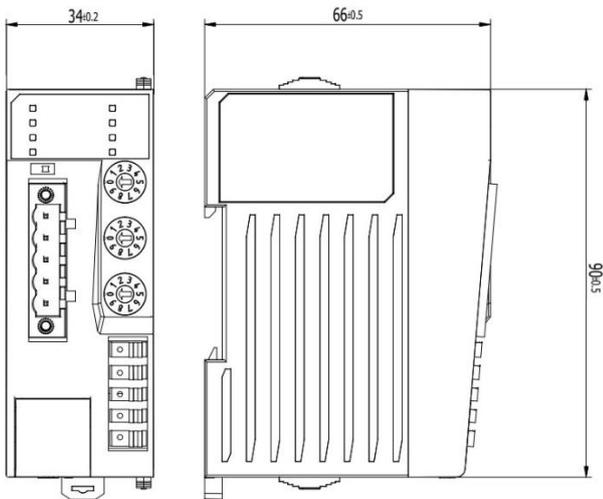
Рисунок 4-3. Размеры коммуникационного модуля SM105007
