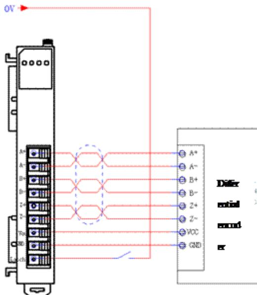
Рисунок 4-22. Схема подключения модуля энкодера SM602103
