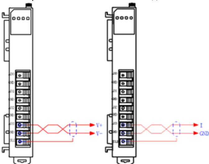
Рисунок 4-17. Схема подключения выходного сигнала напряжения
