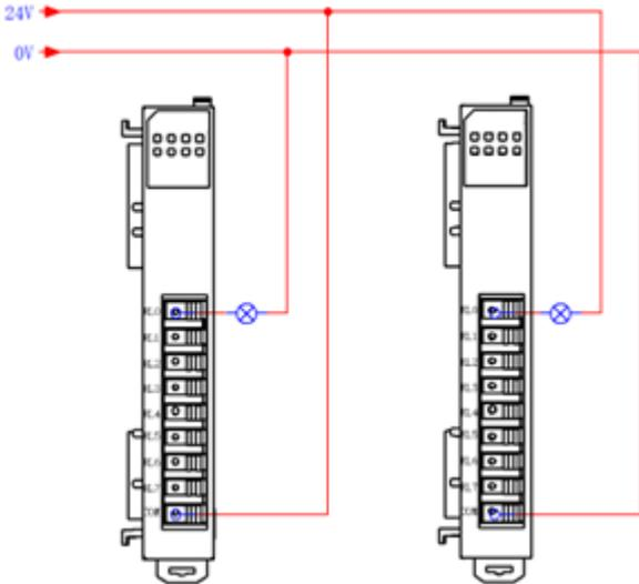
Рисунок 4-14. Схема подключения модуля SM320805 с релейными выходами
