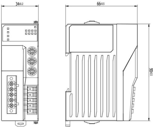
Рисунок 4-2. Размеры коммуникационного модуля SM103003
