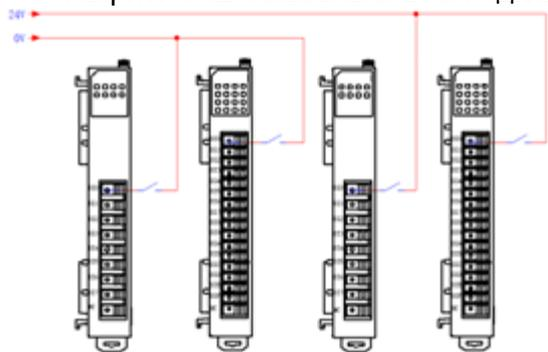
Рисунок 4-12. Схема подключения модуля SM210802/SM210H04
