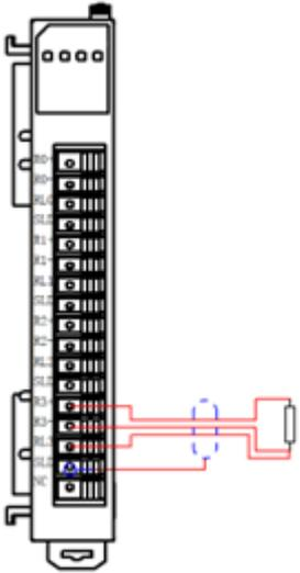
Рисунок 4-20. Схема подключения модуля SM475423
