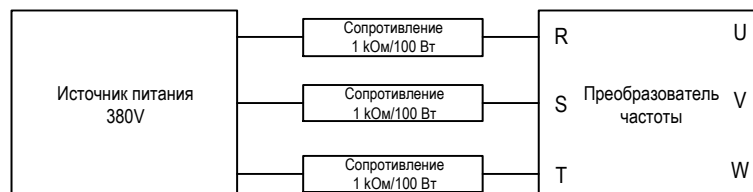
Рис. 7-1 Пример контура зарядки приводного механизма 380 В
