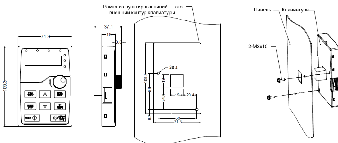
Рисунок 3-19 Конструкция светодиодной клавиатуры
