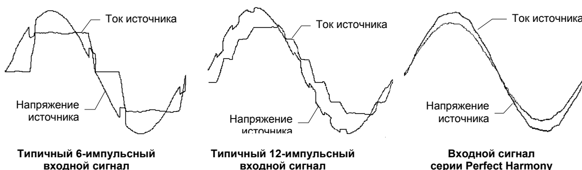
Рисунок 1-1. Гармоническое искажение: сравнение сигналов (6-импульсный, 12-импульсный сигнал и сигнал привода Perfect Harmony)
