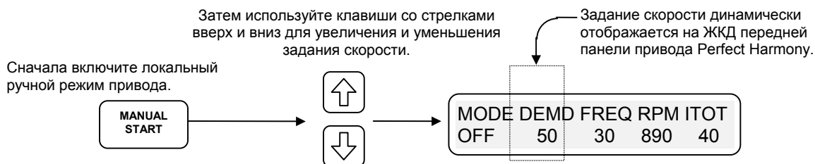
Рис. 3-6. Использование клавиш со стрелками вверх и вниз для регулировки задания скорости
