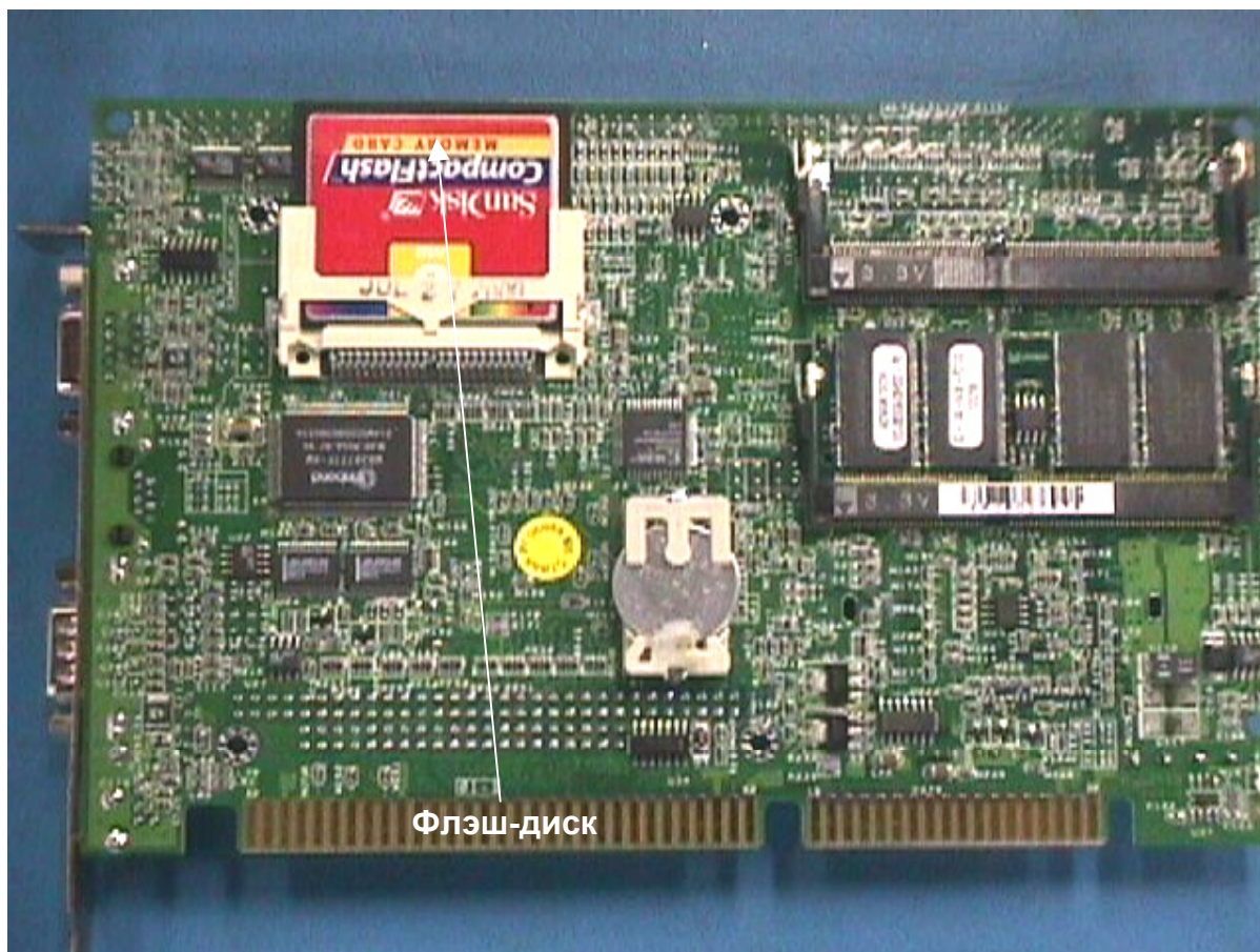
Рисунок 2-13. Расположение флэш-диска на микропроцессорной плате
