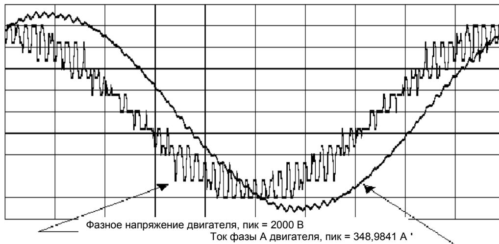
Рис. 6-6. Выходные сигналы привода Harmony 2400 В при полной нагрузке
