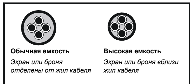
Рис. 4-10 Конструкция кабеля влияет на его емкость
