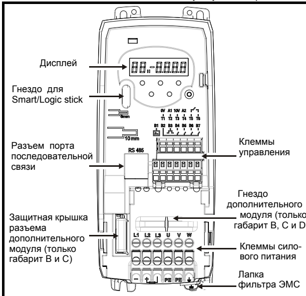
Рис. 3-3 Элементы электропривода (показан габарит В)
